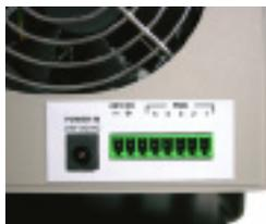
Presente sul retro dello strumento c'è l'interfaccia FMS progettata per una facile integrazione con altre apparecchiature di processo.
