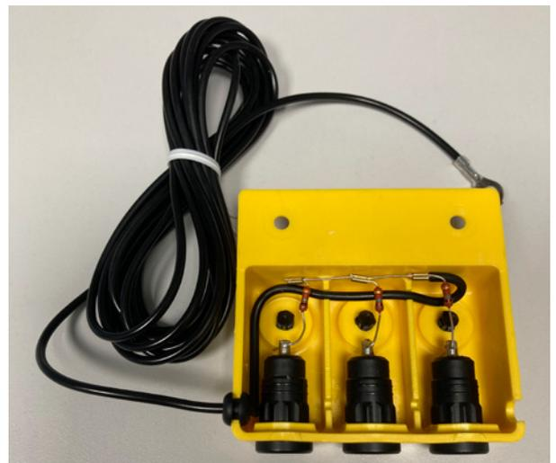
Ogni ingresso viene è protetto elettricamente da un resistore da 1M $\Omega$
