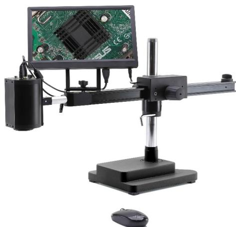
*Sistema di Ispezione avanzato con stativo a sbalzo e telecamera HDMI autofocus*
