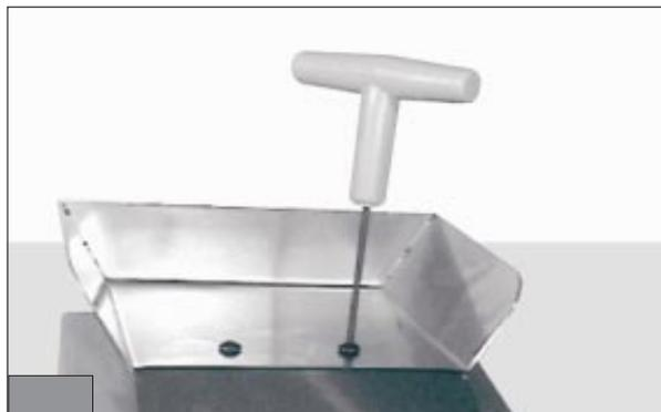
Fissare sulla parte superiore del carter il vassoio porta componenti sfusi.
