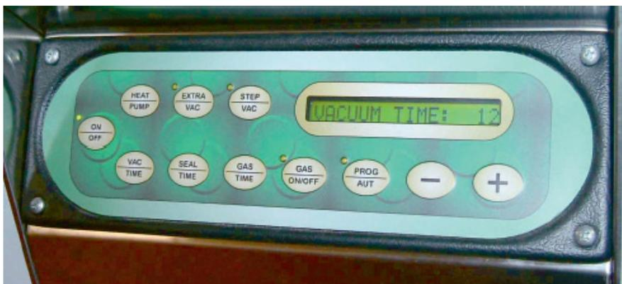
Mediante il pannello di controllo con display è possibile modificare il tempo di saldatura, avviare la pompa del vuoto, allungare il tempo di vuoto, inserire pause durante il ciclo di vuoto e attivare o dissattivare la funzione di gas inerte.
