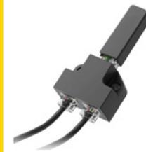
Nuovo sistema anticollisione che riduce il rischio di danni materiali del piano o di un elemento d'arredo durante l'azionamento della scrivania. Questo piccolo dispositivo è basato sul principio del giroscopio, rilevando anche la minima inclinazione del piano sia in direzione di salita che di discesa. In caso di un eventuale ostacolo che impedisce la corretta movimentazione del piano, il sistema si arresta e si muove nella direzione opposta.
