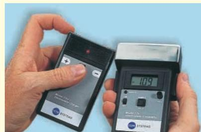
Il kit 9265.503 comprende il misuratore di campo 775, un caricatore a 1100V ed una piastra metallica isolata.
